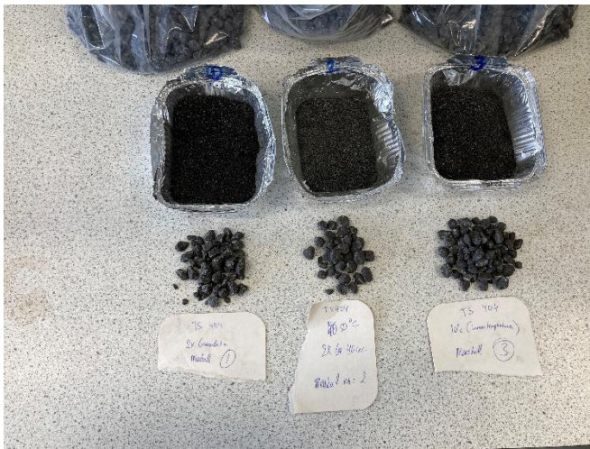
Figuur 3 Drie gegranuleerde en gezeefde speciemonsters
